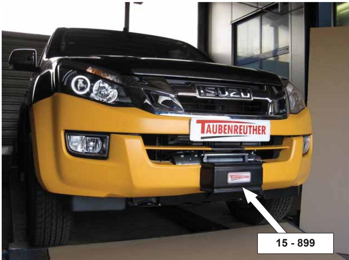
**Hier sehen sie den fertig montierten Seilwindenanbausatz.
